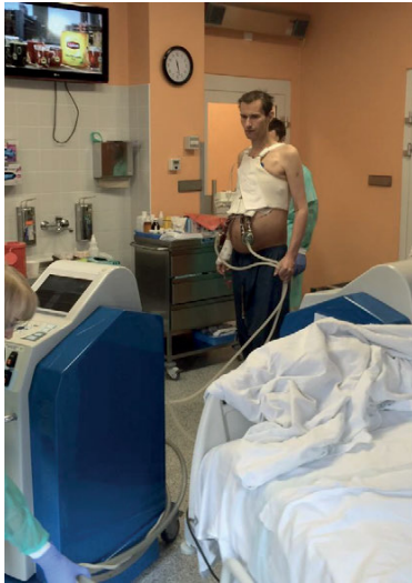
Fot. 3. Chory z implantowanym dwukomorowym systemem POLVAD, podłączonym za pomocą dwóch przewodów pneumatycznych do jednostki sterującej
