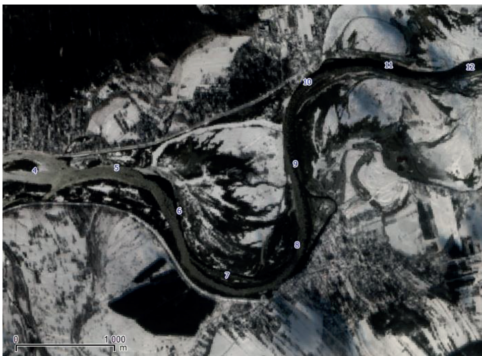
Rys. 4.29. Zator śryżowy w zakolu Bugu i lód w kanale powodziowym Brachnia na obrazie RGB 432 Sentinel-2 w dniu 24 II 2018 r.
