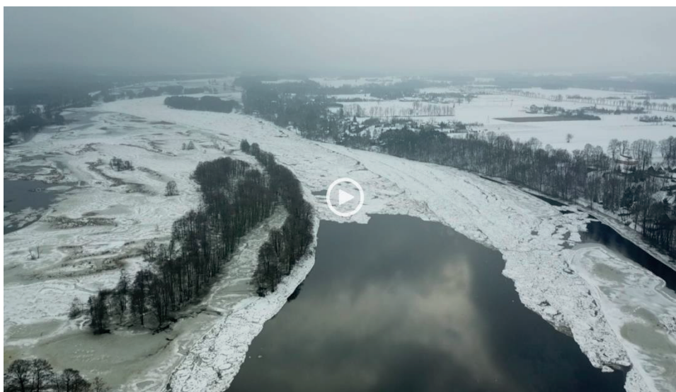
Rys. 4.20. Zdjęcie z drona z 18 I 2018 r. w km 60,0 Narwi – przedstawia napływ lodu w stronę zatoru uformowanego w km 55,4, widoczne jest spiętrzenie poziomu wody w międzywał (dzięki uprzejmości portalu internetowego Pultusk24.pl)
