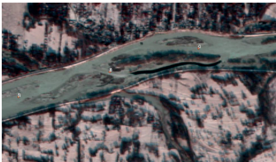
Rys. 2.4. Przetaina nad kanałem ulgi w korycie Bugu między km 3-4 widoczna na kompozycji barwnej 832 z obrazu Sentinel-2 z dnia 17 I 2017
