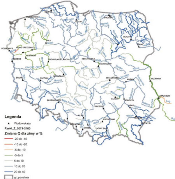
Rysunek 5.7. Procentowa hipotetyczna zmiana średniego przepływu w zimie dla głównych rzek Polski w okresie 2071–2100 w stosunku do okresu 1961–1990 dla scenariusza A2
